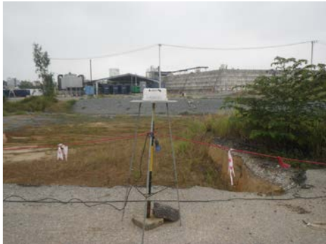
Quan trắc bụi trong khi vận chuyển đất/bùn ô nhiễm từ khu chứa đất vào kết cấu xử lý nhiệt (Ảnh: CDM Smith)
